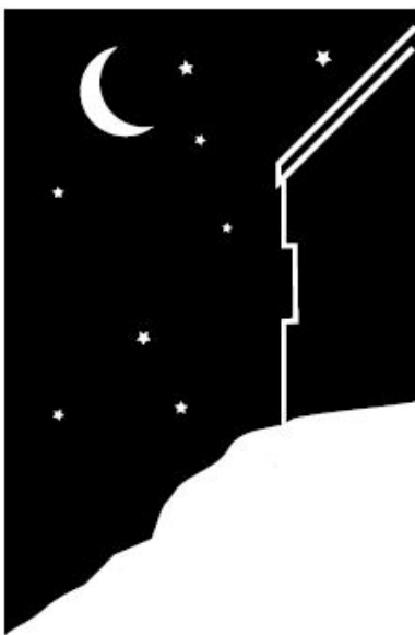
Fönstret placerat långt ut i väggen, avsaknad av avskärmning, klart, kallt väder och hög luftfuktighet är faktorer som kan skapa utvändig kondens.
